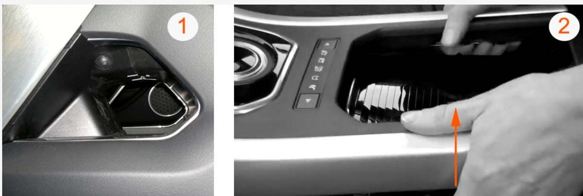
(3) Para poder terminar de levantar la consola debes retirar un conector a cada la lado de la misma como indica la imagen. (4) Ahora podrás pasar el cable de sonido que va desde la salida AUDIO-OUT del interface hasta el reposabrazos. Para poder pasar el cable puedes sacar el plafón de conexiones USB, iPod, AUX original. Este panel está fijado por dos pestañas que se sueltan desde el interior fácilmente una vez retirada la consola central.
