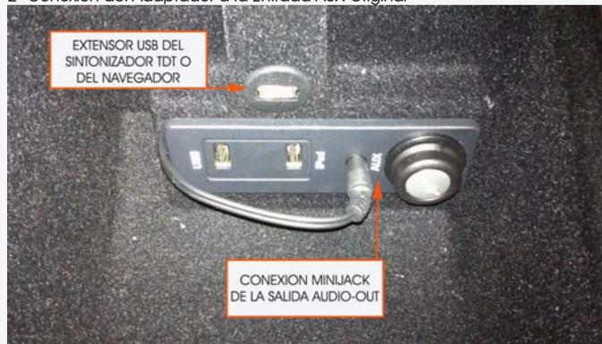
En la imagen adjunta puede ver la conexión entre la SALIDA AUDIO-OUT del cableado C4C-AUDIO y el adaptador MINIJACK STEREO. Necesitará un cable entre 1,5 y 2 mts de longitud en función de la ubicación del interface.
