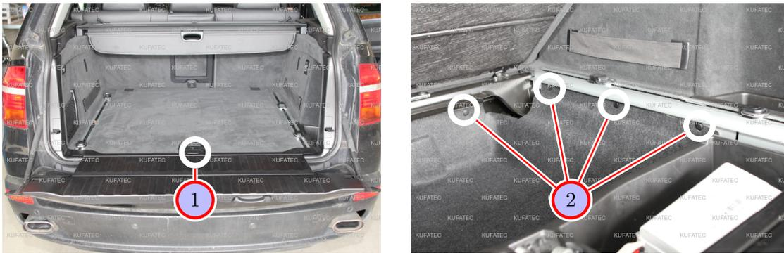
Abbildung 7: Demontage Verkleidung Kofferraum
